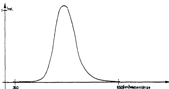
ABBILDUNG 2 Typisches Fluoreszenzspektrum der Naphthalinderivate Relative Fluoreszenzintensität I_{\text{rel}} als Funktion der Wellenlänge (nm); Lösungsmittel: Isopropanol; Spaltbreite des Anregungsmonochromators: 2 nm; Spaltbreite des Emissionsmonochromators: 2 nm.
